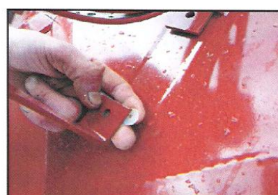
popis 6 Přichycení podpěry s podložkou která musí být mezi šablonou a podpěrou.
